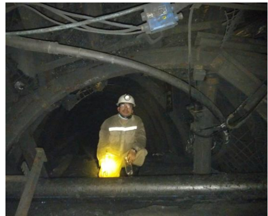
Hình PL 2.4. Hiện tượng biến dạng, lún tại đường lò thượng vận tải 14.5
